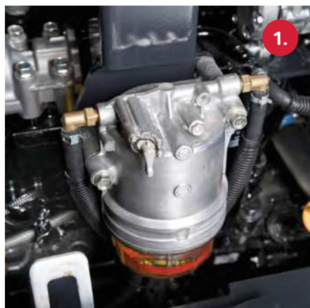
1. Filtr paliwa z separatorem wody 4. Akumulator
