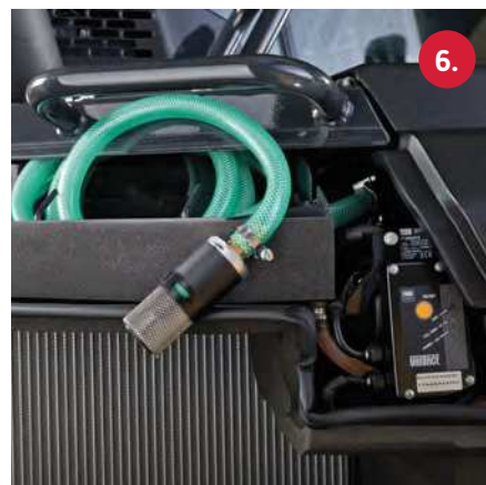
3. Filtr powietrza 6. Pompa tankowania
